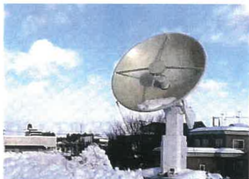
人工衛星追尾パラボラアンテナ (褶動性・耐候性機能)
